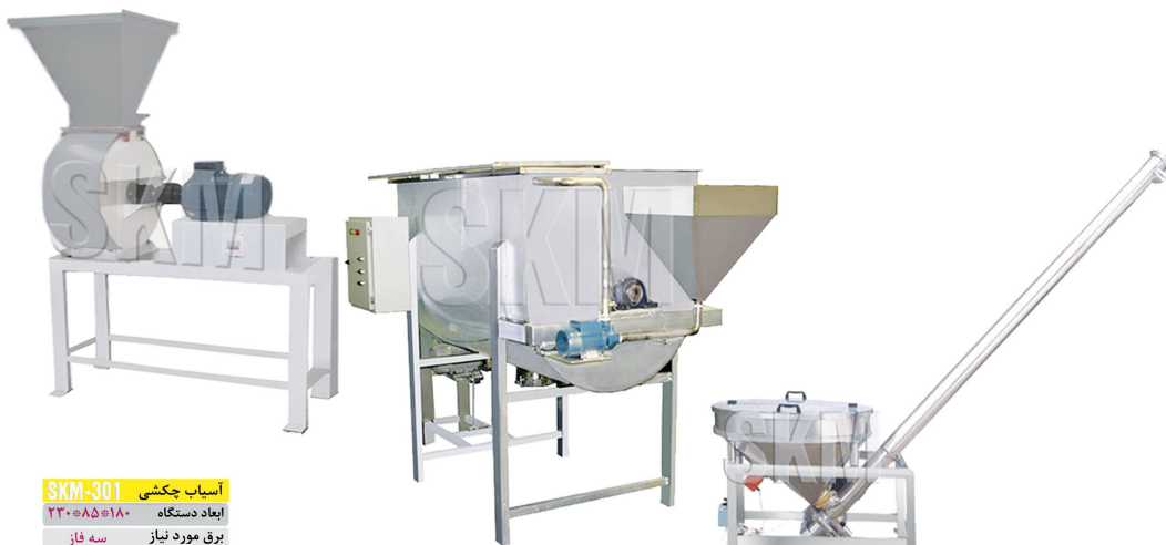
SKM-303 میکسر بلند ابعاد دستگاه ۱۵۰×۱۲۰×۱۴۰ برق مورد نیاز سه فاز/ تک فاز توان برق مصرفی ۱/۵ کیلو وات وزن دستگاه ۵۰۰ کیلوگرم
